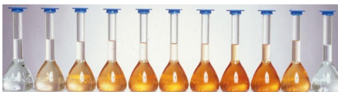
Obr. 2: Zbarvení komplexu \text{Fe}^{2+} -phen pro různé složení směsi.
